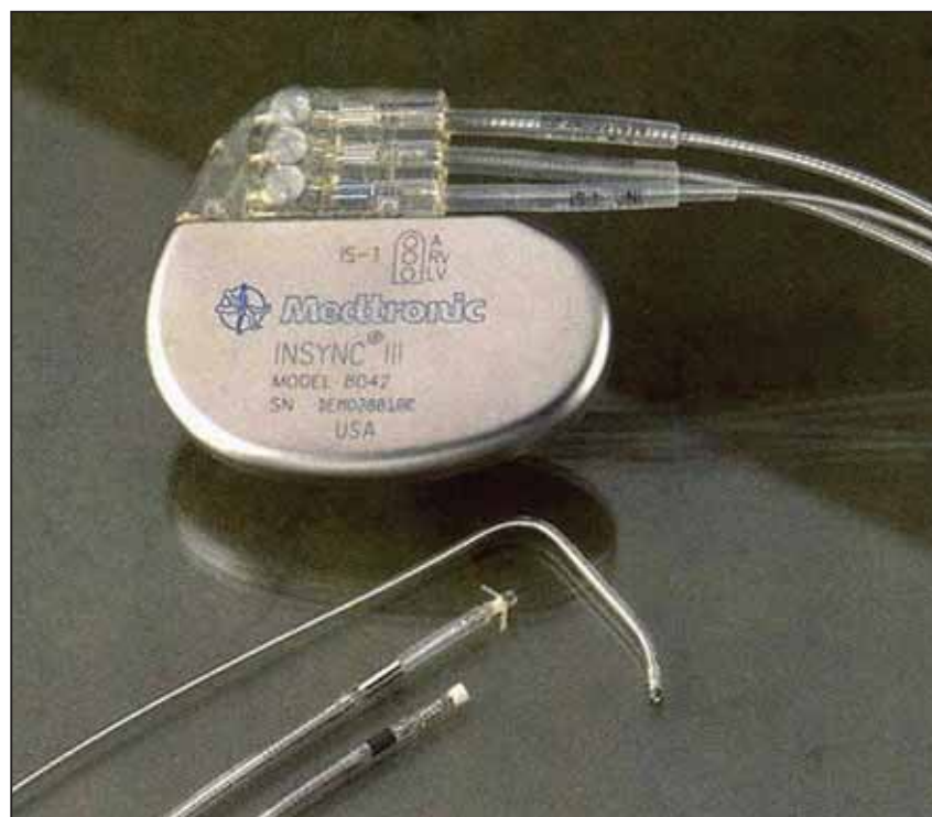
Das neuartige Herzschrittmacher-System hat drei Kabel.
