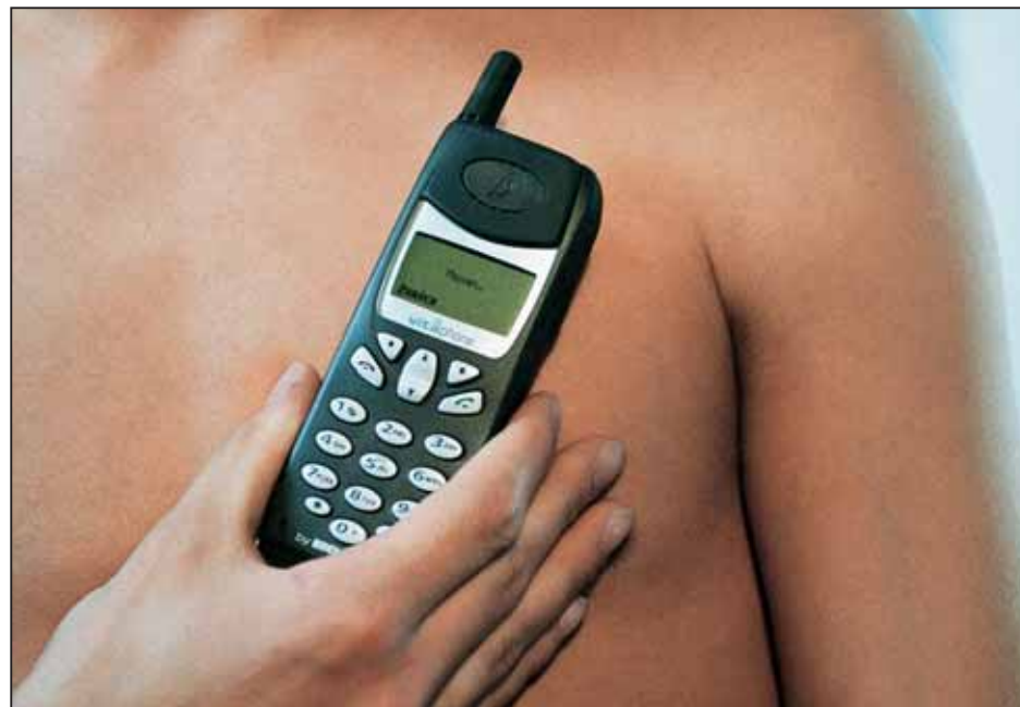
Nachdem die Nummer des Service-Centers angewählt ist, braucht man nur noch das Handy auf die Brust zu halten. Dann werden die Messdaten des EKG über das Herz Handy an das Service-Center übertragen und ein Arzt kann die Daten auswerten.
